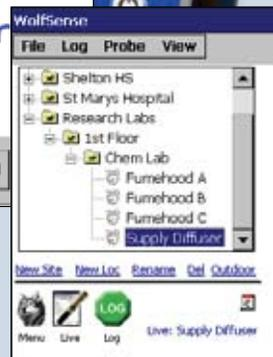
空气流速和流量（风速和风量）读数显示在彩色触摸屏上；一个平均值也能同时被显示；也可选择手动输入读数或一秒钟间隔自动更新的读数来进行各种计算。
