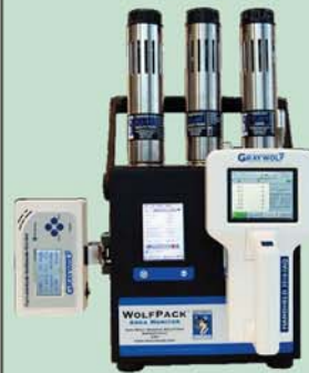
格雷沃夫固定式IAQ检测系统 (连接了PC3016颗粒物检测仪)
